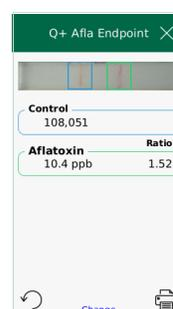
Результаты отображаются в приборе. Образцы с концентрацией более 100 мкг/кг необходимо разбавить и повторно оценить. Чтобы прочитать следующую тест-полоску, нажмите «Change» внизу экрана; это позволяет пользователю ввести следующий идентификатор образца. Нажмите "Accept" и вставьте картридж со следующей тест-полоской.
